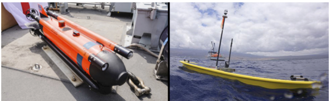
■ Figura 4: De izquierda a derecha, ejemplos de AUV y USV actualmente en operación.
