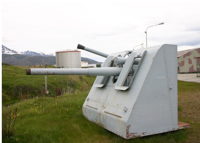
Cañón de 105 mm. en acopio en la BNUS (año 2009). Nótese que en esta foto no posee freno de boca y apagallamas.
