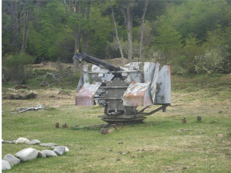
Montaje de 40/60 de Almanza con capa en tubos, sobre afuste de Krupp 88. Atrás se nota el albardón de un cañón de 105 mm
